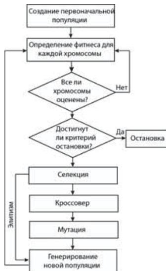
Рисунок 5.2 – Блок-схема генетической оптимизации
