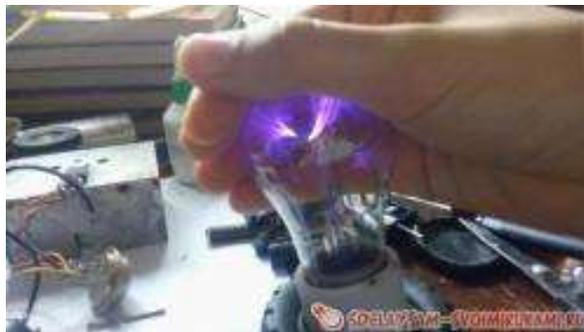
Рис. 6. Искровой разряд внутри лампочки накаливания.
