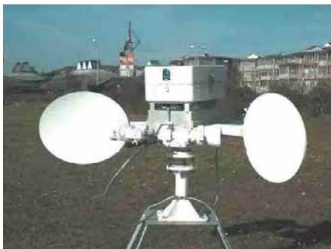
Рис. 1.2 ESA-ESTEC активний радіолокаційний транспондер
