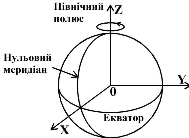
Рис. 3.1. Геоцентрична система координат
