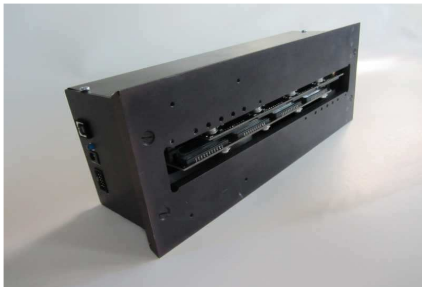
Рис. 4.7 Зовнішній вигляд мультисенсорної камери з шаховою установкою сенсорів і дзеркальними відбивачами [26]
