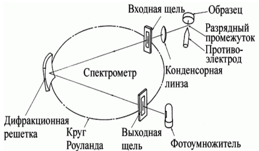
Рис. 1.7 Схема спектрометра з увігнутою дифракційною ґраткою [29]
