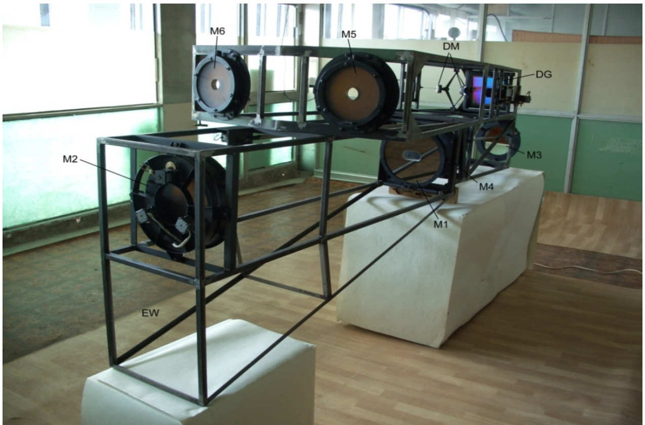
Рис. 3.13 Фотографія спектрогеліографа зі знятою обшивкою. Позначки: EW – вхідна діафрагма, M1 – планоїдне дзеркало, M2 – головне дзеркало телескопа, M3 та M4 – дзеркала коліматора, DG – дифракційна ґратка, M5 та M6 – камерні дзеркала, DM – діагональне дзеркало. [137]
