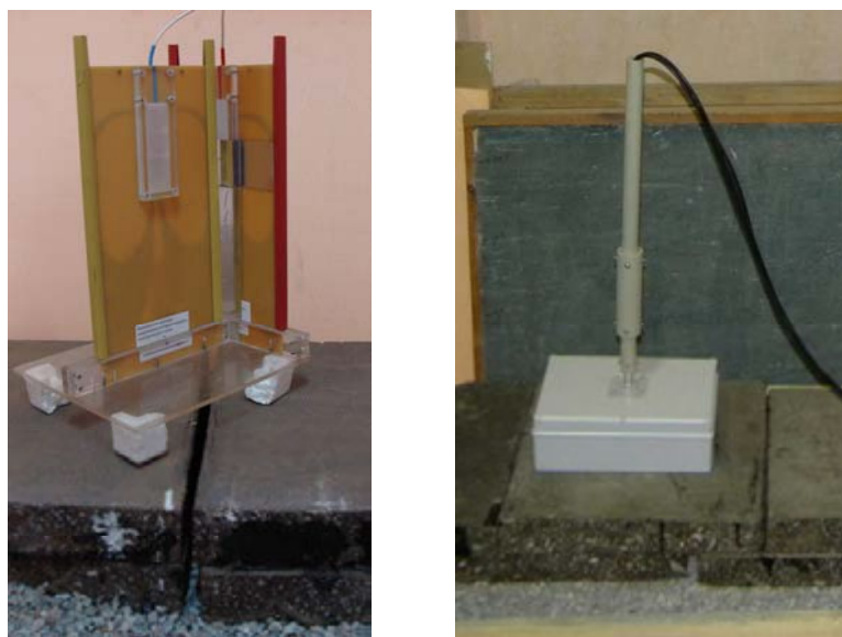
Рис.3 Антенные блоки георадара на модели дорожного покрытия: щель в двух слоях асфальтобетона и щель во втором слое асфальтобетона
