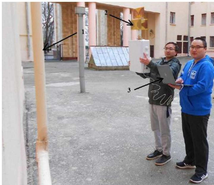
1 – Труба (неоднородность), 2 – антенный блок измерительного комплекса «TRF-1»,
