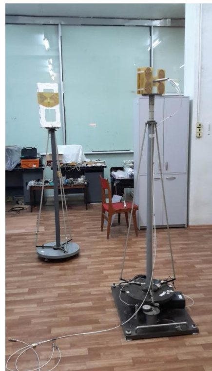
Рис. 4.11 Вимірювальний комплекс. а) схема комплексу із складовими: 1 – генератор імпульсів, 2 – антена, що випромінює, 3 – приймальна антена, реєструюча система, до якої входять: 4 – стробоскопічний перетворювач, 5 – цифрова лінія затримки, 6 – АЦП, 7 – комп'ютер, 8 – блок управління, б) фото поворотного механізму та підтримуючої опори
