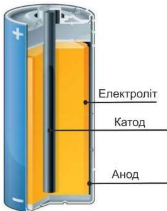
Рисунок 2. Схематичний вигляд батарейки
