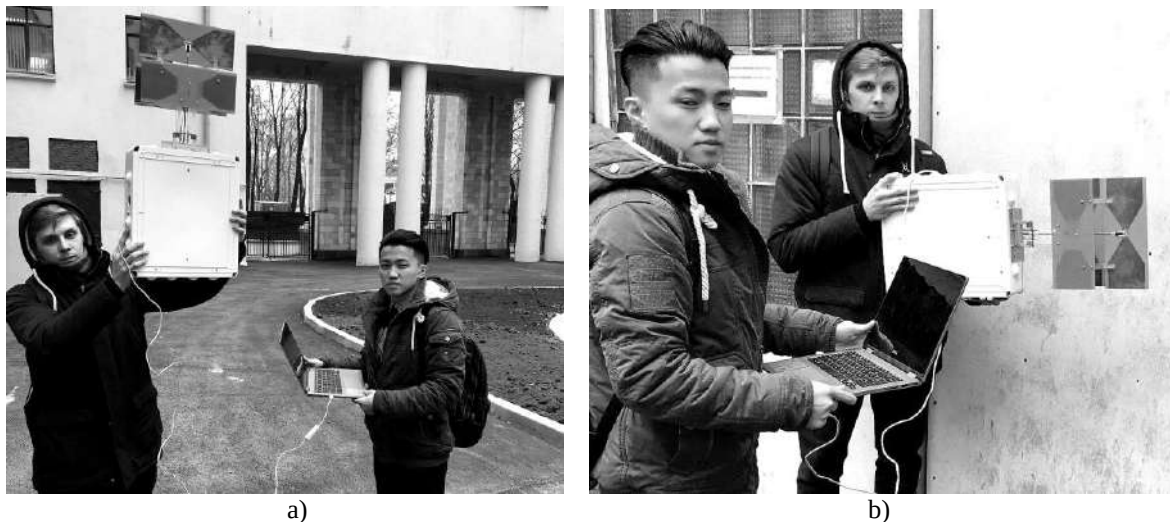
Рис. 1. Георадар «TRF-1» во время регистрации сигнала прямого прохождения (а) и записи сигнала, отраженного от листа металла (b).
